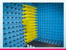
▶ラバーコーティング仕様電波吸収体 痛みの激しいドア周りに耐久性の高い電波吸収体を 貼替えできます。ドアの目印にもなります。
