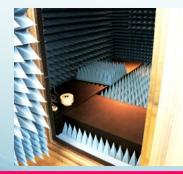
▶歩行用電波吸収体 電波暗室内を安全に歩行できる様に設計された 電波吸収体です。
