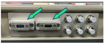
電波シールドボックス内部へ引き込みの可能なフィルタ内蔵のコネクタモジュールです。 USB3.0がリリースされました。USB1.0とUSB2.0とも互換があります。 デモ機を準備しております。その実力を実機でお試し下さい。
