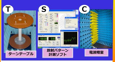
電波吸収体は、周波数帯に合わせて取替可能 UHF帯からミリ波帯まで各周波数帯に対応します
